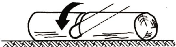
Rys. BB.104-Pień podparty wzdłuż całej długości
