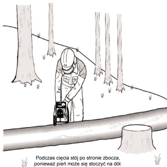
Rys. BB.107-Skracanie pnia
