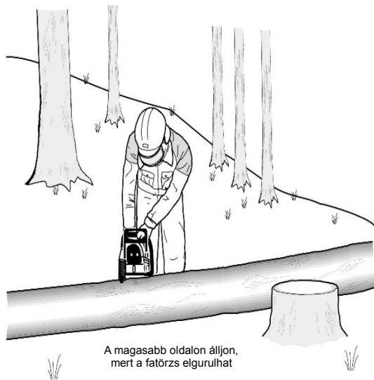
BB.107 ábra Fatörzs aprítása
