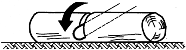
BB.104 ábra Teljes hosszában alátámasztott fatörzs
