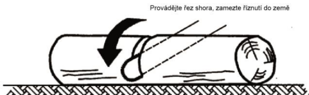
Obr. BB.104-Kmen podepíraný v celé délce
