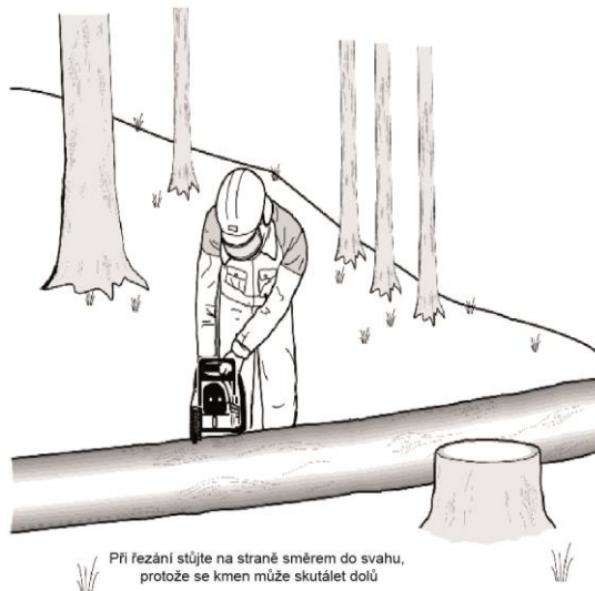
Obr. BB.107-Zkracování kmene
