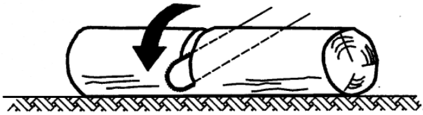
Ilustracija BB.104-Deblo podprto po celotni dolžini
